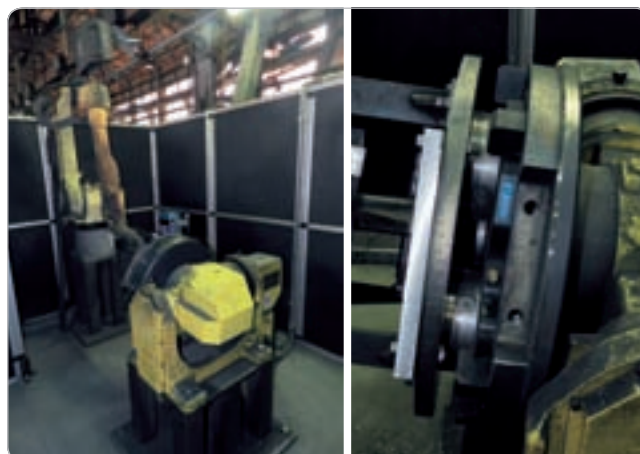
Obr. 1 Robotizované pracovisko vybavené robotom FANUC (vľavo) a detail polohovadla robota s nainštalovaným upínacím rýchlovýmenným modulom VERO-S
