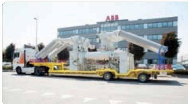
Obr. 3 Kompletné mobilné 420 kV pole určené na špeciálne alebo núdzové použitie
